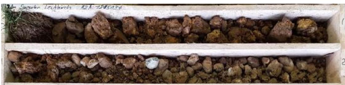
Abbildung 15: BK 2: Vega/ Braunauenboden über Kiesverwitterungshorizont
