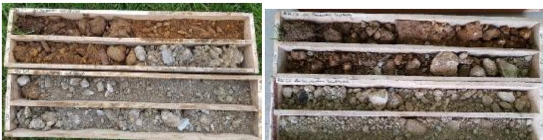
Abbildung 9: Aufschluss BK 5.1/18 und 5b/18, Kolluvium
