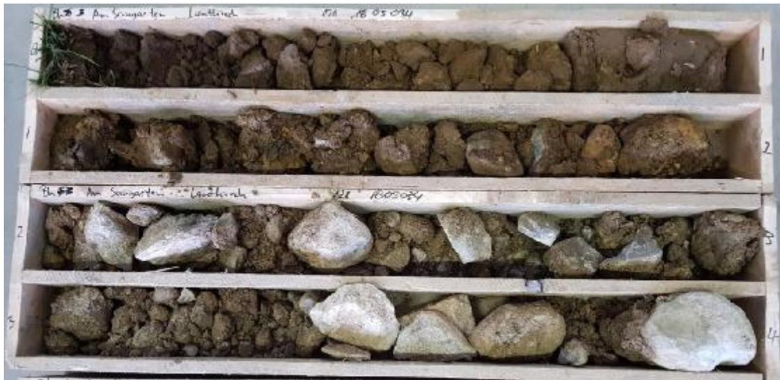
Abbildung 16: BK 3: Braunauenboden über Auenlehm über Kolluvium
