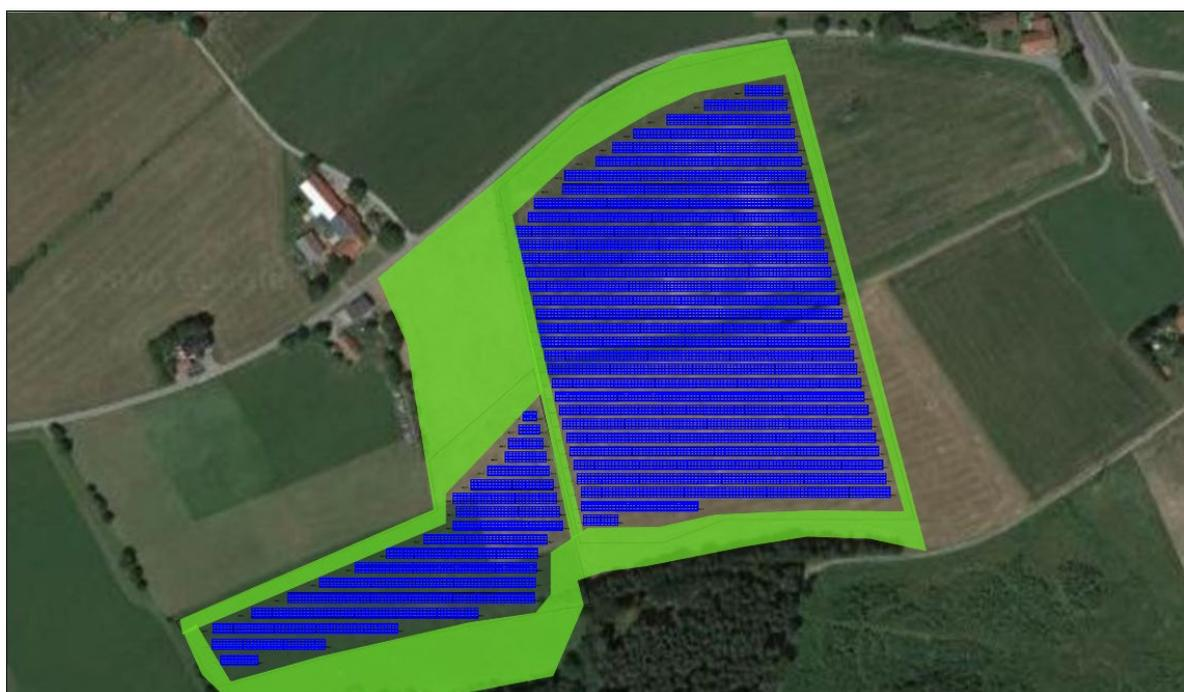
Abbildung 8 Vorentwurf Modulbelegung mit 10 MWp – Grüne Flächen für Eingrünung und Ausgleichsmaßnahmen
