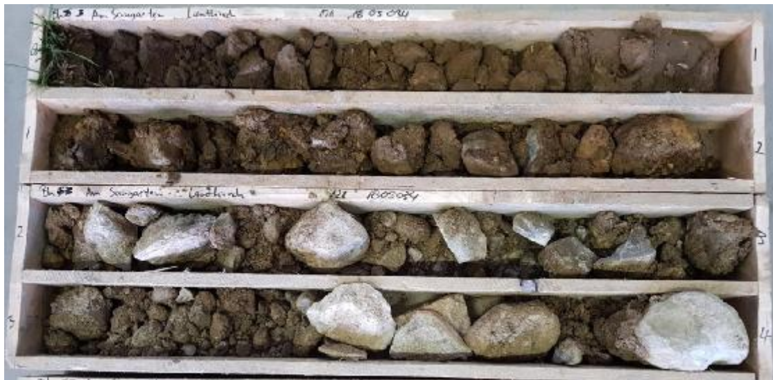
Abbildung 16: BK 3: Braunauenboden über Auenlehm über Kolluvium
