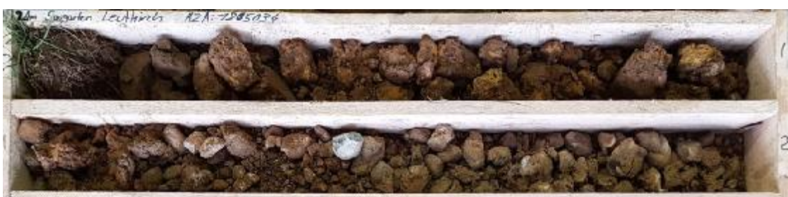
Abbildung 15: BK 2: Vega/ Braunauenboden über Kiesverwitterungshorizont
